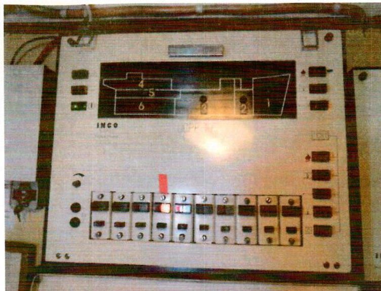
Fot. 12. Widok centrali sygnalizacji pożarowej typu UCPP-10 na statku SV Dar Pomorza
