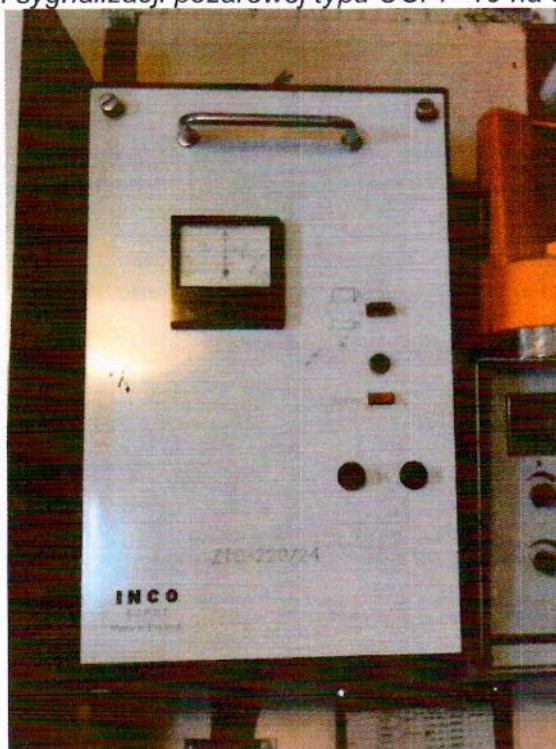
Fot. 13. Widok zasilacza sygnalizacji pożarowej typu ZTC-220/24 na statku SV Dar Pomorza
